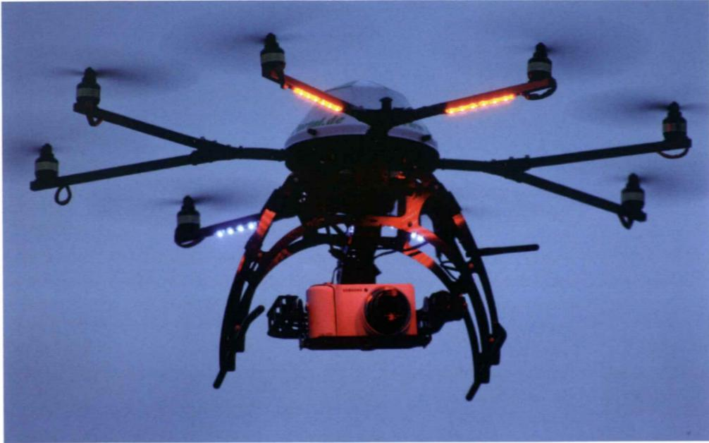
◀ Drohne mit acht Rotoren (Oktokopter), Android-Kamera und 3G-Funk
