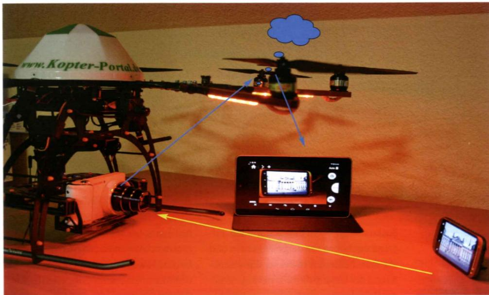
◀ Cloud-Service, Tablet-PC zur Kamera-steuerung (Bildmitte) und Livebild über das Gerät rechts unten
